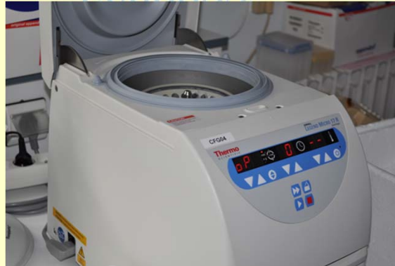
Centrifugation 10 000 tr/min (5°C) 4 min Mélange du surnageant avec le réactif Bradford
